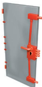
Serrure de sécurité prédisposée pour cylindre à profil européen. La clé de dimensions réduites actionne trois verrous centraux, le demi-tour et les deux verrous latéraux positionnés dans la partie haute et basse de la porte.
